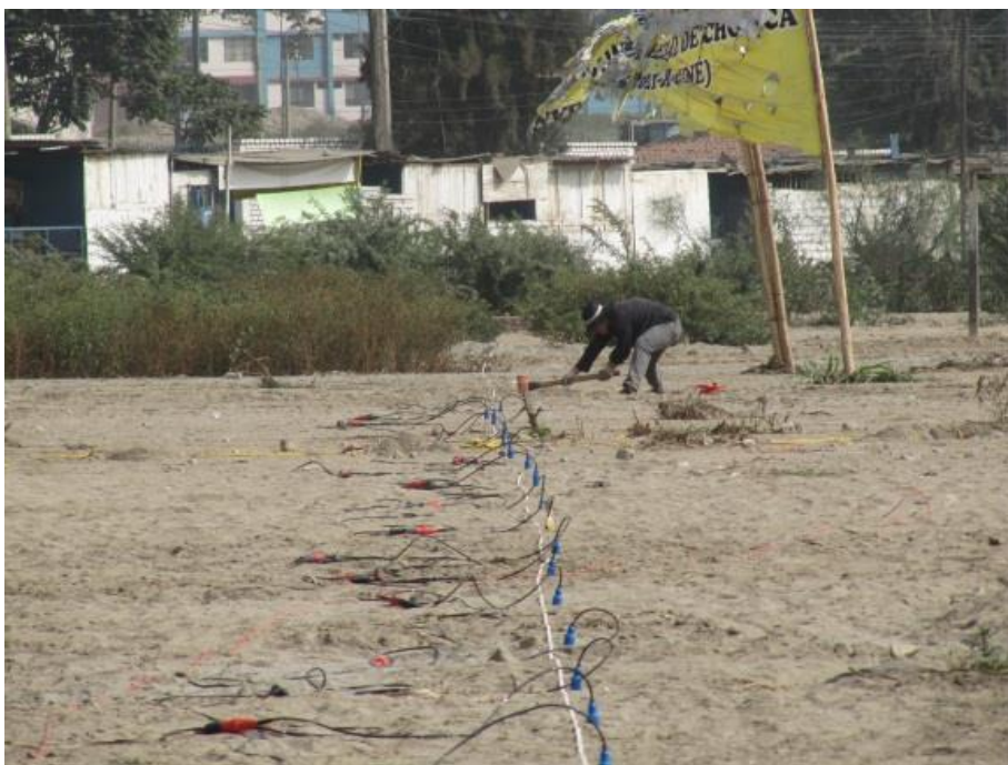
Figura 45: Imágenes de la disposición del equipo de refracción sísmica para la toma de data en el área urbana de Chosica
