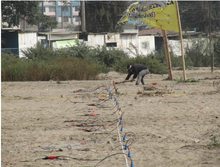
Figura 7: Imagen de la disposición del equipo de refracción sísmica para la toma de datos
