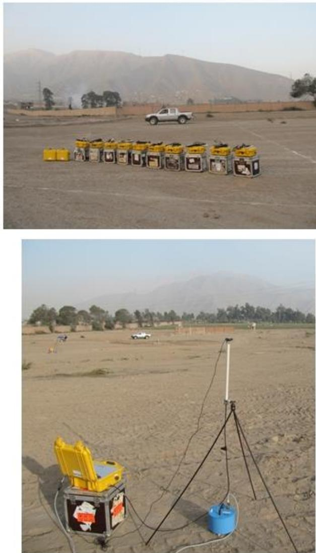
Figura 43: Imágenes de los arreglos sísmicos circulares realizados en Huaycán. Se muestran los equipos utilizados y su disposición a diferentes distancias radiales.
