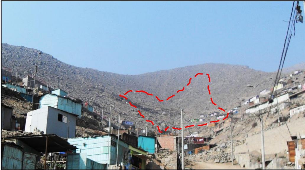
Figura 20: La línea segmentada de color rojo nos muestra caída de rocas de 8" en los alrededores de la Zona H-L.
